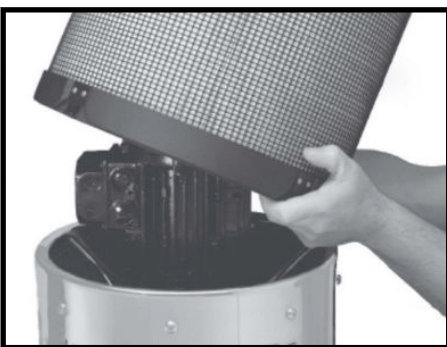
Trinn 4. Kontroller etterfilteret (hvis montert) og bytt ut om nødvendig.
