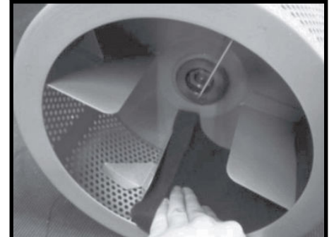
Trinn 6. Monter nye trommelputer.
