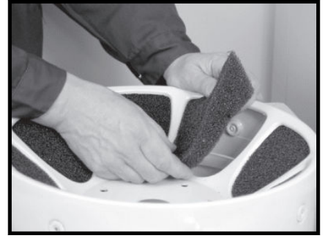
Trinn 12. Fjern gammel lyddemper og monter ny lyddemper.
