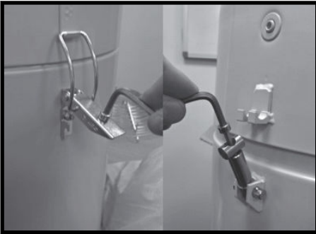
Trinn 1. Fjern sikkerhetslåsen og klipsene.
