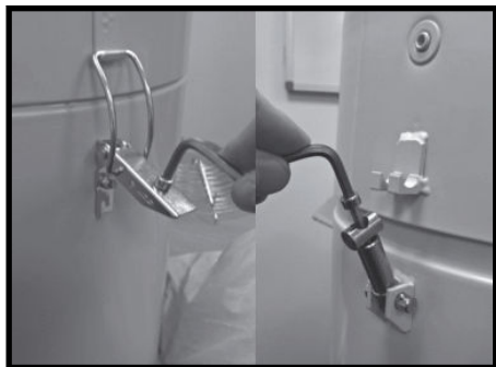
Trinn 1. Fjern sikkerhetslåsen og klipsene.
