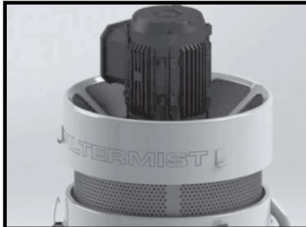
Trinn 2. Separat topp og bunn av saken.
