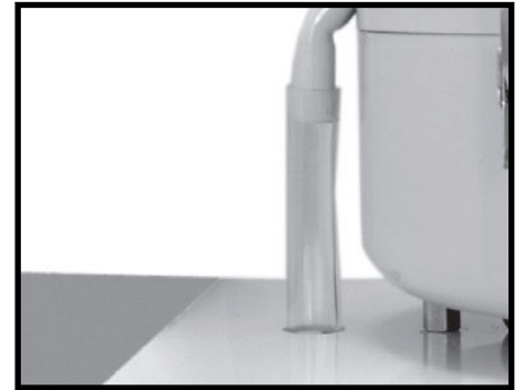
Trinn 3. Kontroller oljereturslangen for skader og blokkering.
